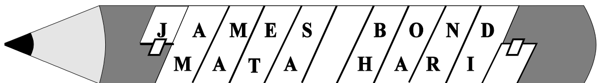
Abbildung 1: Einfache Nachbildung einer Skytale
